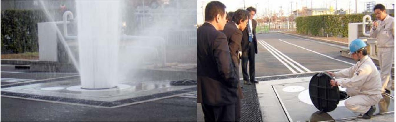
水圧試験とマンホール蓋の機構の説明。水圧で水が吹き出す(右)が、ロック機構付きの蓋は外れない。
